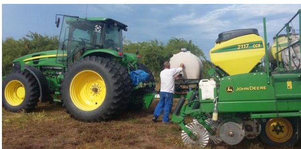
Figura 2. Trator agrícola modelo 7210J e semeadora-adubadora, modelo 2117 CCS, 15 linhas ambos da marca John Deere.
