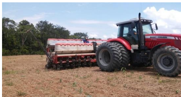
Figura 2. Conjunto trator semeadora durante operação de semeadura. Fonte: Gibbert (2018)
