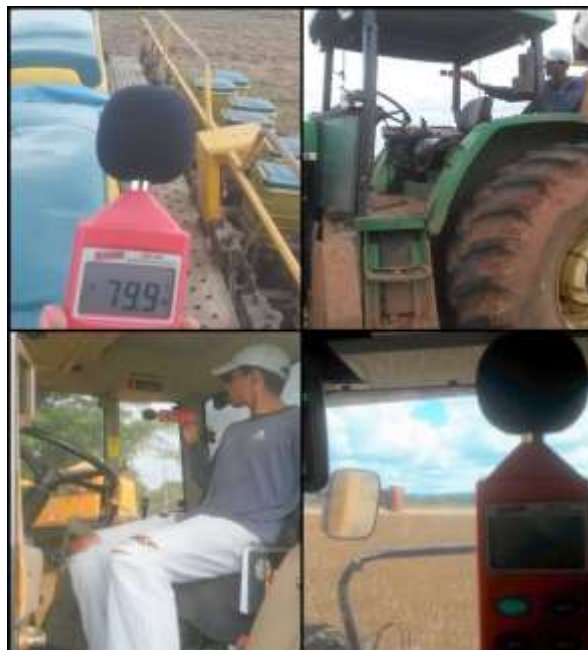
Figura 1. Medição do nível de ruído com o decibelímetro nos diferentes maquinários, conforme as normas da ABNT. Fonte: do autor.
