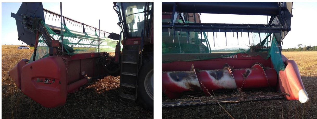
Figura 2. Detalhes da plataforma de corte (25 pés) onde observa-se uma tela verde fixada lateralmente e posteriormente, com a função de reduzir perdas de grãos devido ao impacto dos mecanismos móveis da plataforma. O molinete estava com apenas 3 barras condutoras (metade).
