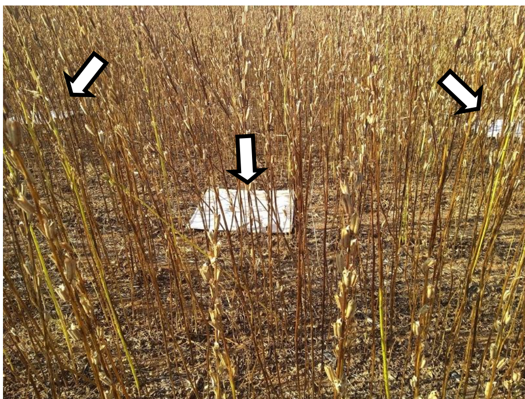
Figura 4. Detalhe dos gabaritos com tecido colocados na lavoura imediatamente antes da colheita, sendo que os grãos retidos debaixo foram considerados perdas naturais e os grãos de cima após passagem na colhedora, considerados perdas da máquina.
